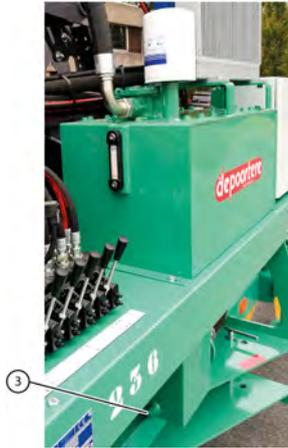
Fig. 137: Vidanger le réservoir hydraulique
