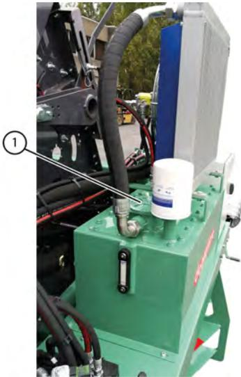
Fig. 105: Filtre de retour réservoir hydraulique
