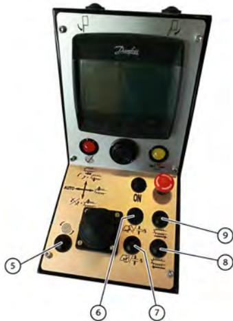
Fig. 67: Vérifier le fonctionnement des boutons de la console de commande
