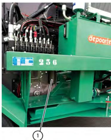
Fig. 95: Remplacer le filtre à haute pression
