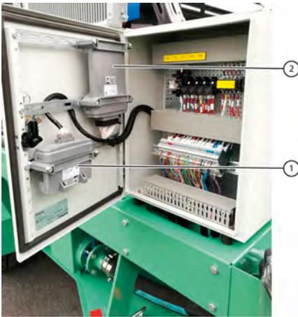
Fig. 116: Emplacement des contrôleurs
