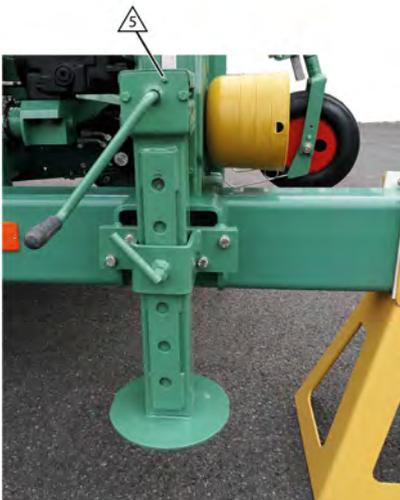
Fig. 113: Lubrifier la béquille mécanique
