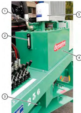
Fig. 14: Réservoir hydraulique
