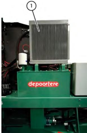
Fig. 96: Nettoyer le radiateur de l'huile hydraulique
