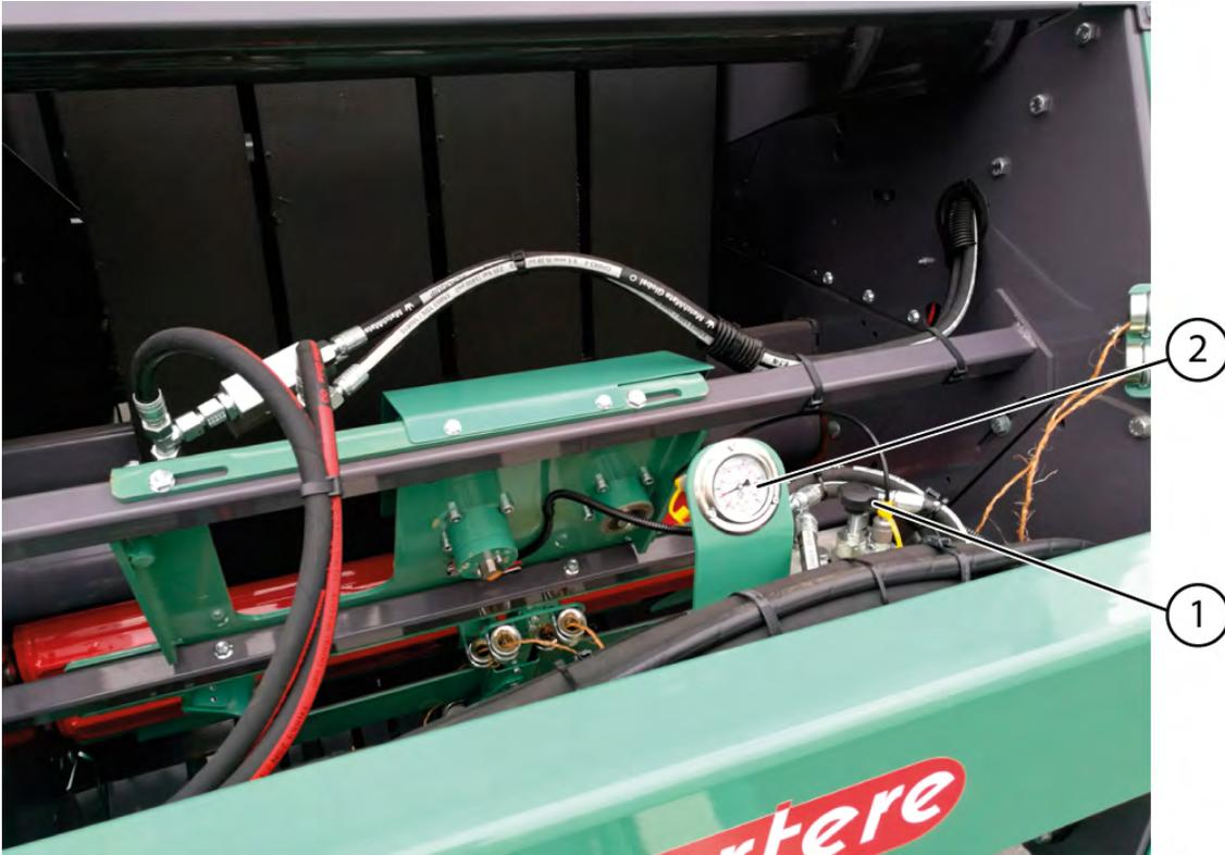
Fig. 83: Régler la pression de serrage dans la cage
