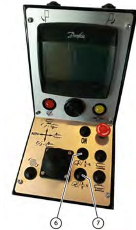
Fig. 69: Régler l'épaisseur de la nappe de lin avec la console de commande
