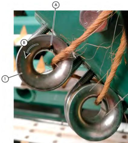
Fig. 106: Usure d'un guide ficelle
