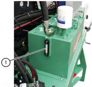
Fig. 101: Niveau huile hydraulique
