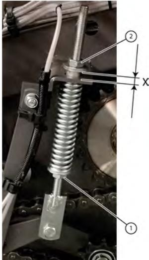
Fig. 86: Régler le tendeur de chaîne automatique
