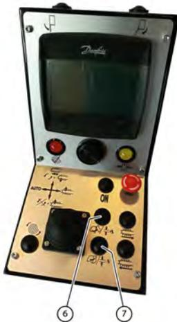
Fig. 68: Ouvrir et/ou fermer la cage avec la console de commande
