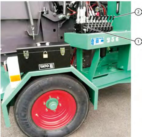
Fig. 10: Bloc de soupapes
