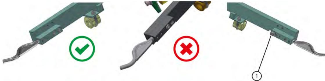
Fig. 132: Vérifier l'emplacement du bloc du doigt
