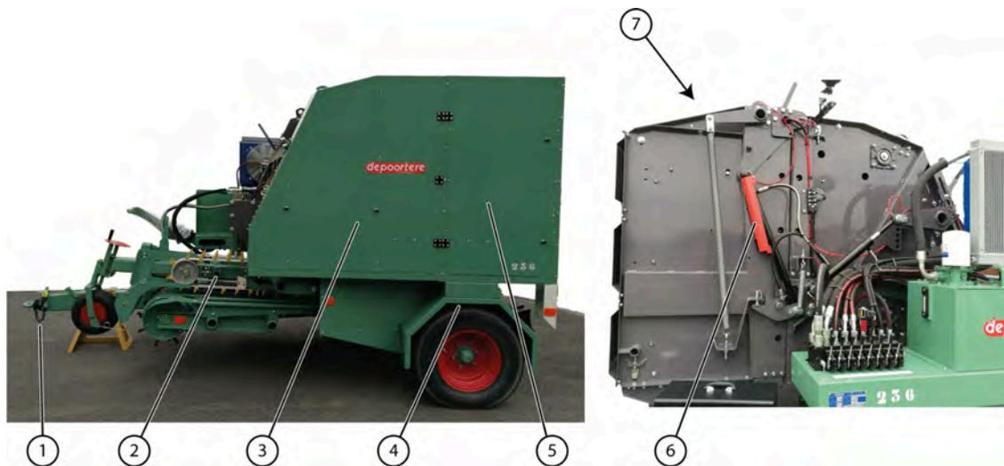
Fig. 29: Représentation des dispositifs de sécurité
